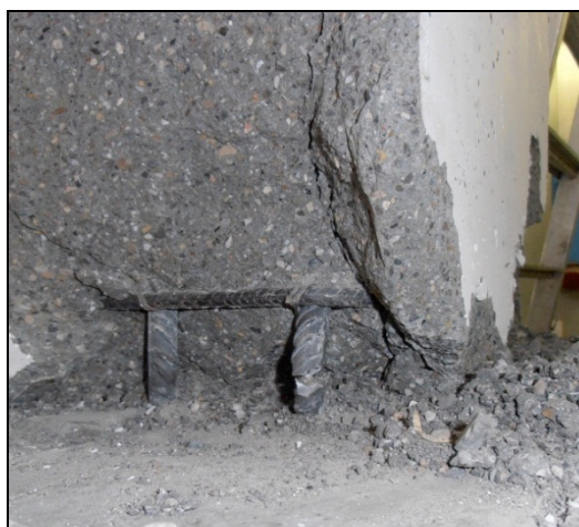
Figura 7. Rottura dell'armatura longitudinale durante la prova.
