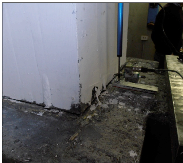
Figura 9. Frattura alla base del pilastro.
